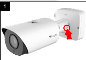
1 Die Verschraubung am Wandarm mit zwei bis drei Umdrehungen lockern. Nicht komplett lösen!
